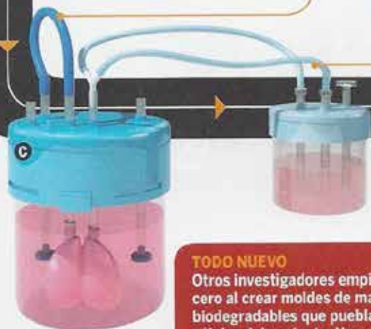
BIORREACTOR. La matriz se introduce en un depósito a la temperatura del cuerpo.
